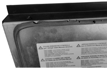
Fig. 24 - Junta deteriorada
