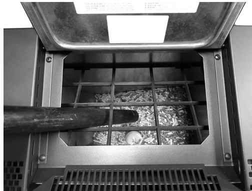
Fig. 34 - Limpieza depósito y coclea
