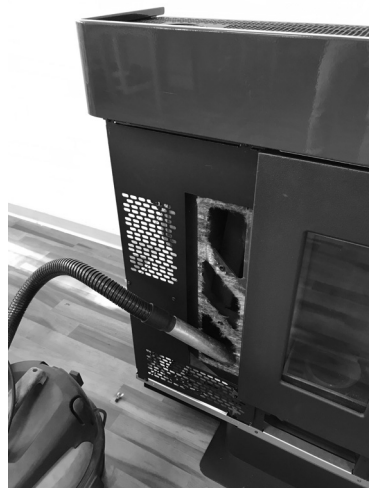
Fig. 38 - Limpieza cámara de humos
