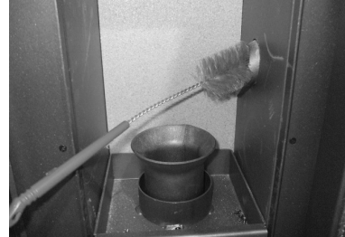
Fig. 33 - Limpieza con escobilla
